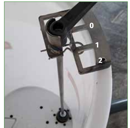
6- Pour démarrer l'écoulement du ragréage ouvrir la vanne en tournant la poignée en position 1 puis déplacer la station latéralement.
