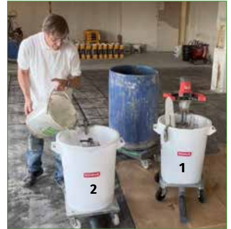
3- Pendant ce temps là commencer à préparer la station « MIX PERFORMER 2 » avec de l'eau.
